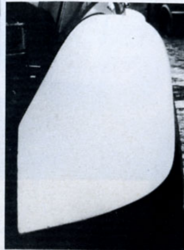
Kotflügel glatt, innenverbreitert, zur Verwendung von 7-Zoll-Felgen ohne Distanzscheiben 2030 links 190,- 2031 rechts 190,-
